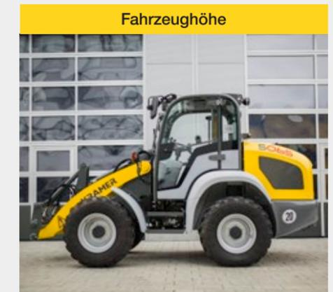
Die Maschinen bieten beste Voraussetzungen für niedrige Durchfahrthöhen. Alle Maschinen haben eine Gesamthöhe unter 2,5 m. Durch die kompakte Bauweise beim Radlader 5050 ist ein unkomplizierter Transport auf einem 3,5 t - Anhänger möglich.
