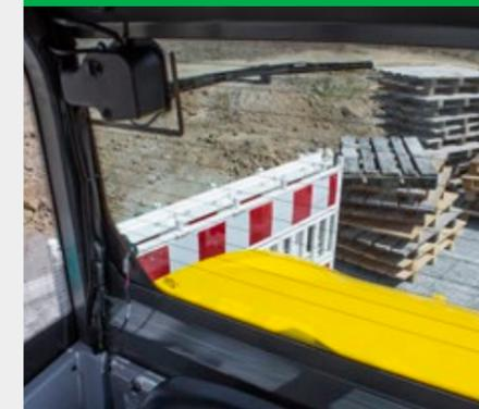
Durch die Freisichtkabine und die optimal positionierte B-Säule ist eine hervorragende Rundumsicht gegeben. Eine Panoramafrontscheibe ist serienmäßig verbaut. Die flach abfallende Batteriehaube sorgt für eine hervorragende Sicht nach hinten. Zusätzlich befindet sich mittig auf der Haube eine Finne zur besseren Orientierung beim Rückwärtsfahren.
