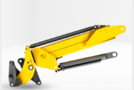
Die kompakte Kastenbauweise der Teleskopladeanlage macht die Sicht auf das Anbaugerät einzigartig. Die Vorteile der Z-Kinematik: Beim Einkippen der Schaufel wird bei gleicher Zylindergröße eine höhere Reißkraft erzeugt, da die Kolbenseite des Hydraulikzylinders beim Einkippen beaufschlagt wird.
