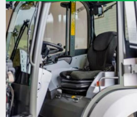
Die Fahrerkabine ist über einen breiten Einstiegsbereich einfach und bequem zu erreichen. Hierzu gehören zwei großflächige Trittstufen, die treppenförmig untereinander angeordnet sind. Des Weiteren sind diese rutschhemmend und bieten bei jeder Witterung Sicherheit für den Fahrer. Die Haltegriffe sind in einer gut erreichbaren und greiffreudlichen Position angebracht.
