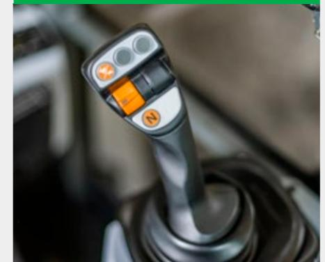
Am Joystick ist die Taste für die beiden Fahrstufen integriert: Schildkröte und Hase. Der Fahrer hat jederzeit die Möglichkeit die maximale Fahrgeschwindigkeit komfortabel anzupassen. Dies ist auch während der Fahrt möglich. Das jeweilige Fahrstufen-Symbol wird im Display angezeigt. Die maximale Fahrgeschwindigkeit ist auch vom jeweiligen Fahrmodus abhängig.
