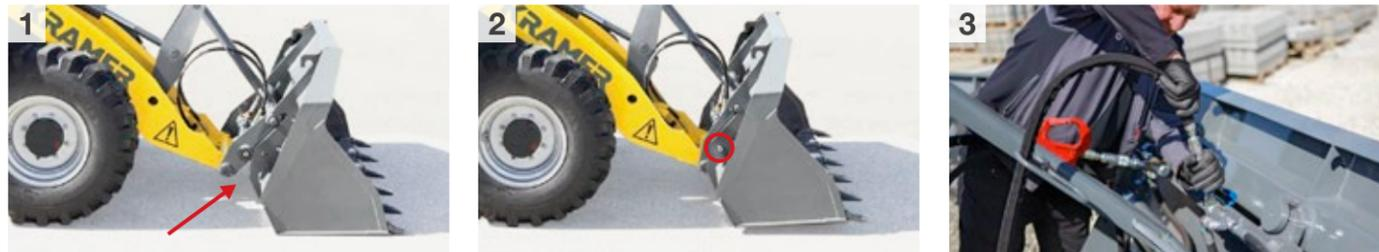
Mit dem hydraulischen Schnellwechsler kann der Werkzeugwechsel einfach von der Kabine aus vorgenommen werden. Das Schließen des Verriegelungsbolzens wird per Tastschieber am Joystick durchgeführt. Beim Wechsel von Anbaugeräten mit hydraulischer Zusatzfunktion ist durch das manuelle Kuppeln der Schläuche ein Aussteigen des Fahrers erforderlich.
