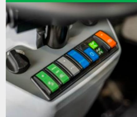
Die zwei Fahrmodi, Eco und Power (PWR) können über einen Kippschalter bestimmt werden. Beim Eco-Modus wird unter anderem die Fahrgeschwindigkeit auf maximal 14 km/h reduziert. Somit kann der Fahrer Energie einsparen und gewinnt an zusätzlicher Laufzeit. Beim PWR-Modus hat das Fahrzeug die volle Fahrzeugleistung. Die Fahrgeschwindigkeit beträgt maximal 20 km/h.
