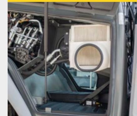
Die Reinigungsklappe befindet sich auf der rechten Seite der Kabine. Die Klappe ist durch einen Griff von unten nach oben zu öffnen und wird durch einen Dämpfer fixiert. Ein einfacher Zugang zum Kabinenluftfilter und Hauptsteuergerät ist somit gegeben. Die Reinigung des Kabinenbodens kann sehr einfach vorgenommen werden.
