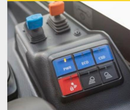
Das Feature beim 5040 umfasst drei per Knopfdruck wechselbare Fahrmodi, um der jeweiligen Anforderung möglichst effizient zu begegnen. Der Power-Modus (PWR) eignet sich für Schaufelarbeiten, der ECO-Modus für Stapelarbeiten oder Straßenfahrten und die Langsamfahreinrichtung (CSD) für hydraulische Anbaugeräte.
