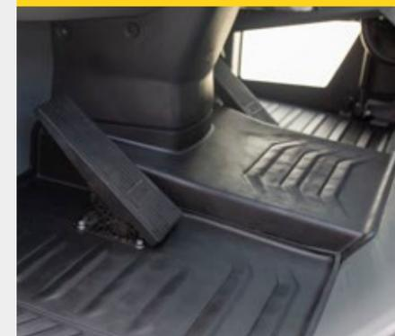
Der Mitteltunnel im Kabinenboden hat durch das Design des Fahrzeugrahmens eine Höhe von nur 5 cm. Dem Fahrer wird somit ein komfortables Ein- und Aussteigen ermöglicht. Der Mitteltunnel ist ebenfalls mit einer Gummimatte überzogen und kann leicht gereinigt werden.
