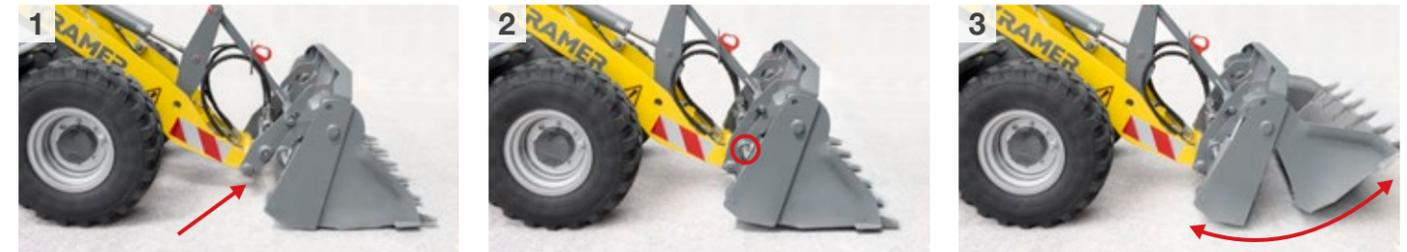
Smart Attach ist ein hydraulischer Schnellwechsler, kombiniert mit einem automatischen Kupplungssystem, das von Kramer selbst entwickelt wurde. Das manuelle Umstecken der Hydraulikschläuche entfällt und der Fahrer muss die Maschine nicht mehr verlassen. Die Bedienung erfolgt wie gewohnt über den Joystick direkt aus der Kabine.
