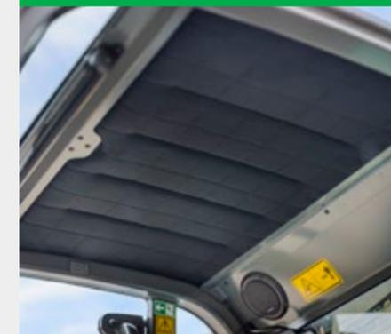
Die Kabine verfügt neben der Luftheizung über eine jeweils optional energiesparende Front- und Heckscheibenheizung, Sitzheizung sowie einer Flächenheizung. Dadurch werden gezielt bestimmte Bereiche erwärmt, anstatt das gesamte Luftvolumen. Die Flächenheizung befindet sich im Fahrzeugdach und unterhalb des Fahrersitzes. Zusätzlich ist die Kabine mit Dämmmatten gut isoliert, sodass die Wärme nicht verloren geht.
