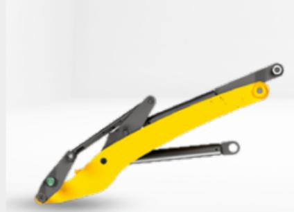
Die parallel geführte Ladeanlage gewährleistet konstante Hubkraft und eine sichere Bedienung im Materialumschlag. Durch einen Rückkippwinkel von bis zu 45° und einen Auskippwinkel von bis zu 45° verliert der Radlader im Schaufeleinsatz auch bei hohem Füllgrad kein Material und ermöglicht ein vollständiges Entleeren der Schaufel.
