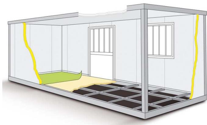
Die ca. 40mm dicken Wände sind genauso rundum isoliert wie das Dach. Dank eines Rahmens aus stabilen Stahlprofilen ist der Container sehr verwindungssteif. Der Boden besteht aus wasserdichten Holzpaneelen, unterstützt durch 18mm starke Stahlprofile.
